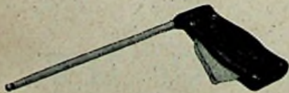
Moderne draadtang, tevens te gebruiken voor het in positie houden van weerstanden etc. tijdens het solderen
